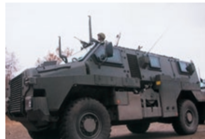
同じく左側面。車体上部には銃架やワイヤーカッターなどが装備されている
